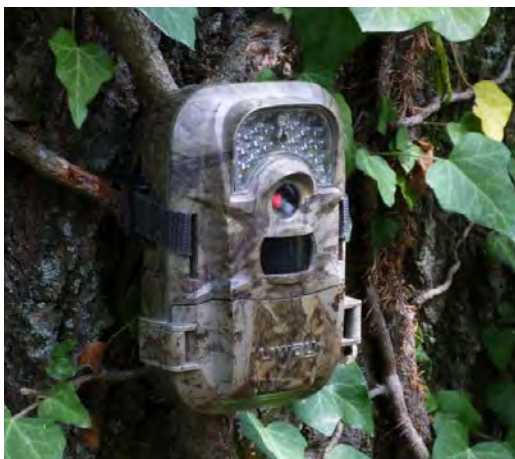
Figura 3.19 - Esempio di modello di fototrappola utilizzata per scatti o riprese in sequenza – Foto di Adriano De Faveri (ISPRA)
